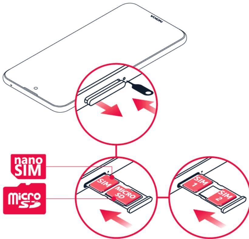
1. Ouvrez le tiroir de la carte SIM : poussez la tige de l'outil d'ouverture dans l'orifice du plateau et ouvrez celui-ci en le faisant glisser.
